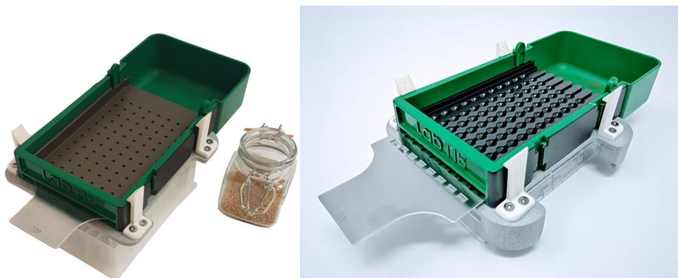
Figura 5 Dispositivo LabTie para distribución de semillas en 96 pocillos. Imagen tomada de Dispensador LabTie para la colocación de semillas en placas de 96 pocillos. Imágenes tomadas de https://www.labtie.com/product-page/96-well-arabidopsis-seed-dispenser
