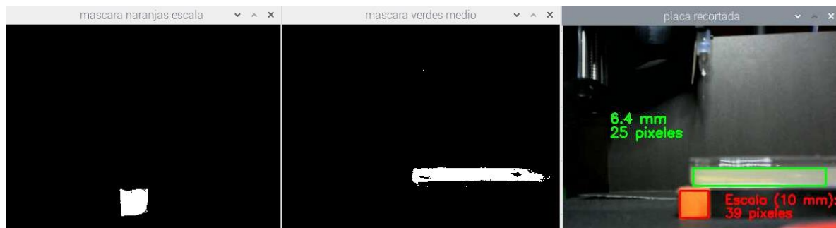
Figura 24 Determinación de la profundidad del medio de cultivo en una caja de Petri usando la captura en vivo de video de la cámara lateral del robot y el script mide_profundidad_v2envivo.py . Izquierda: Máscara producida por la segmentación por color de la escala naranja usando el rango BGR (min [0,110,240], max [59,154,255]). Centro: Mascara resultante de la segmentación por color del medio de cultivo con el rango BGR (min [130,170,175], max [170,220,225]). Derecha: rotulado con las medidas del ancho de la escala y el medio de cultivo, junto al cálculo de la profundidad del medio de cultivo en base a estas medidas.
