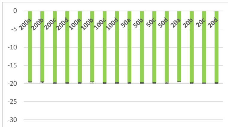
Figura 22 Mediciones obtenidas sobre el la profundidad del medio de cultivo contenido en una placa de Petri. El procesamiento de datos fue similar a la de la Figura 21 pero sobre lecturas que incorporaron una transformación morfológica de apertura en el reconocimiento del medio de cultivo y la escala de referencia. Se observa una mejor significativa en la reproducibilidad de la medida de profundidad del medio de cultivo. En el eje de las ordenadas se muestra el valor, expresado en milímetros, del desplazamiento en el eje Z corregido por la medida de la profundidad del medio de cultivo. Las barras de error representan el valor de desviación estándar para cada uno de los valores promedio calculados.
