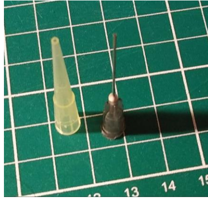
Figura 30 Comparación de una punta descartable de micropipeta p200 y de una aguja hipodérmica calibre G22.
